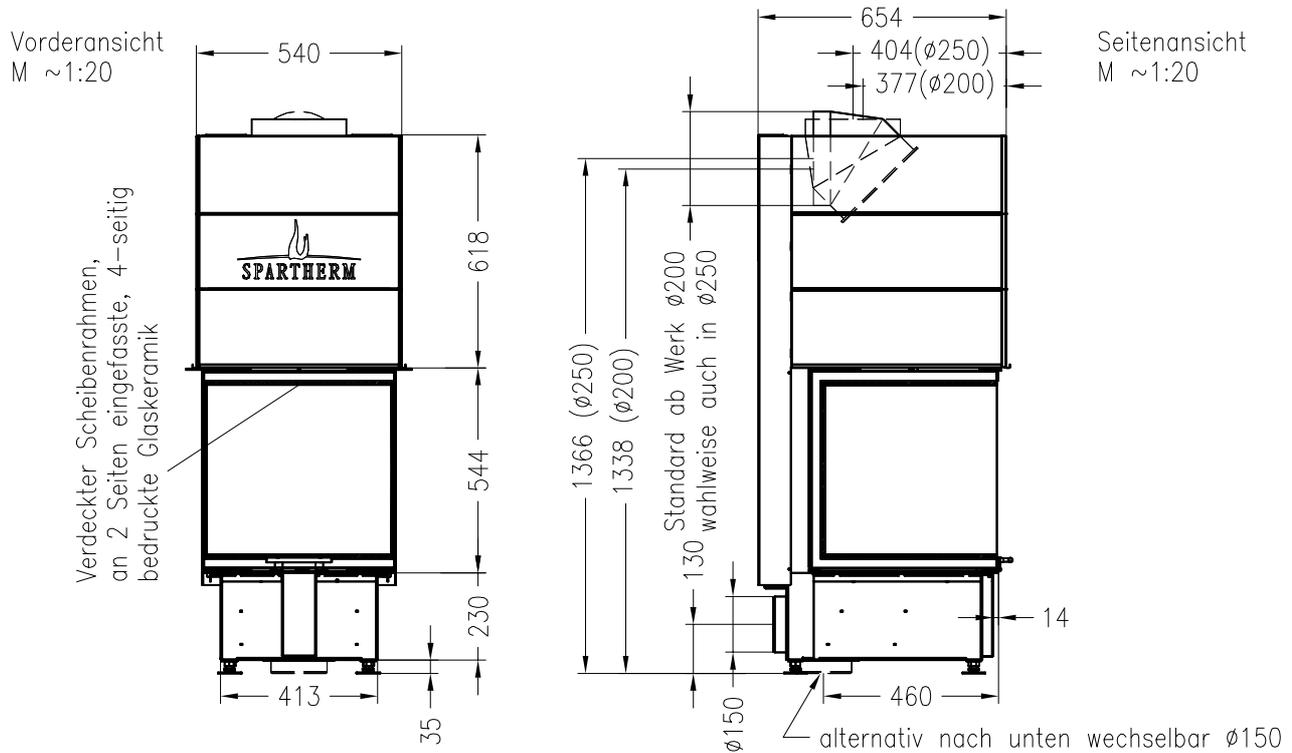
ACHTUNG: Gerät geprüft mit Abgasdurchmesser ø200, alternativ auch mit ø250 erhältlich!
